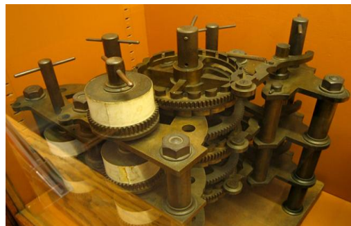
Fig. 16 - Componentă a mașinii de calcul inventată de Charles Babbage (1833)
