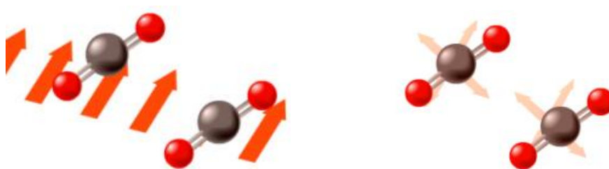
Mecanismul microscopic al absorbției și al reemisiiei radiației infraroșii
